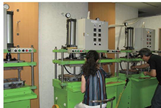
店の奥の工場に設置された機械で、インソールを成型中
